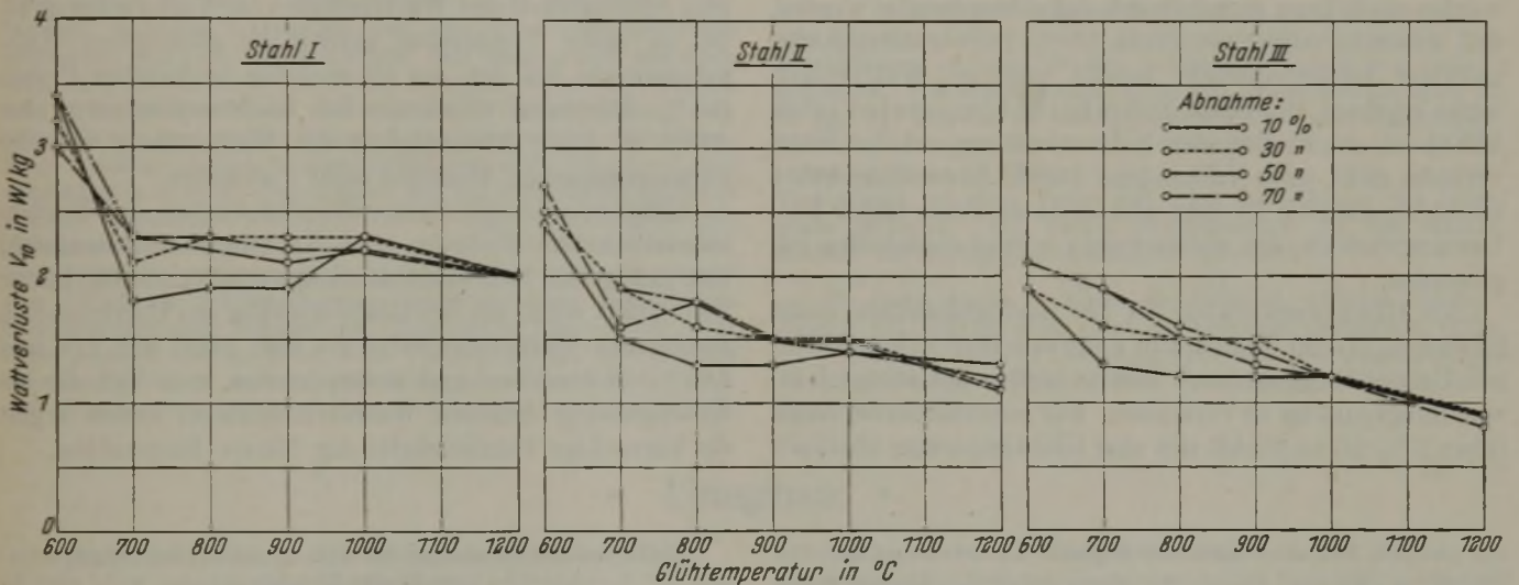
Bilder 6 bis 8. Abhängigkeit der Wattverluste von der Glüh­temperatur für Abnahmen von 10, 30, 50 und 70 % (Versuchsreihe II); Banddicke 0,35 mm.
