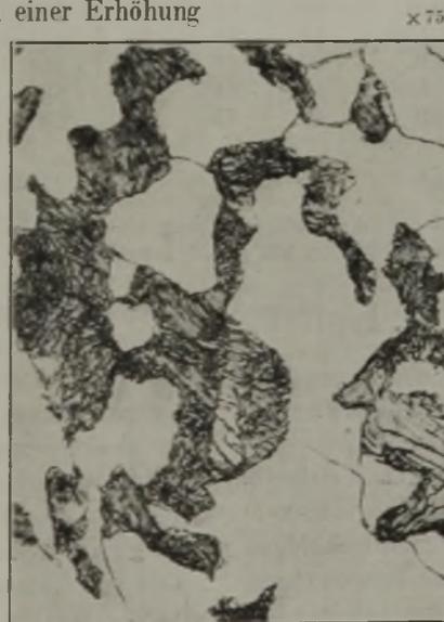
Bild 3. Behandlung: 900° Luft + 450° Luft. Dauerstandfestigkeit bei 400° = 20 kg/mm<sup>2</sup>.
