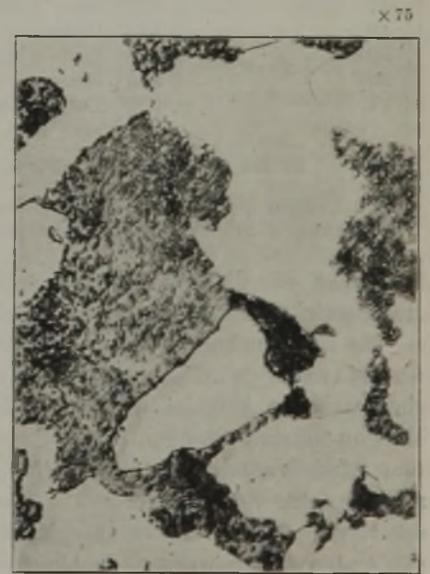
Bild 4. Behandlung: 900° Luft + 450° Luft + 650° Luft. Dauerstandfestigkeit bei 400° = 16,5 kg/mm<sup>2</sup>.
