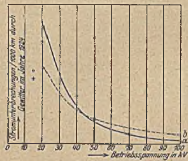
Abb. 11. Gewitterstörungen (im Jahre 1924) bezogen auf gleiche Leitungslängen, in Abhängigkeit von der Betriebsspannung.
