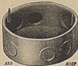
Abb. 2. Universal-Papier-Abzweigdosen mit verbleitem Eisenmantel und auswechselbarem Metallbandverschluß (Zungenverschluß), für 8 Rohranschlüsse.
