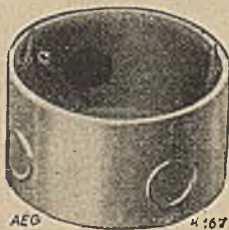
Abb. 1. Universal-Papier-Abzweigdosen mit verbleitem Eisenmantel und auswechselbarem Metallbandverschluß (Zungenverschluß), für 4 Rohranschlüsse
