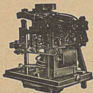
Druckschalter mit Motorschutz offen
