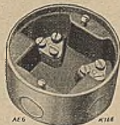
Abb. 5. Universal-Abzweigdosen aus Tenacit mit verbleitem Eisenmantel für 4 Rohranschlüsse und mit 2 eingepreßten Messingklemmen.
