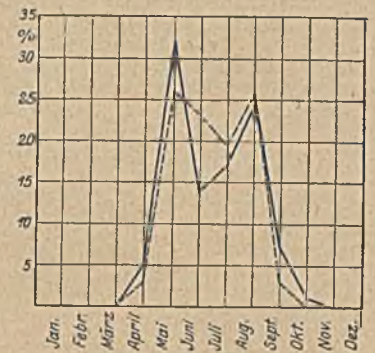
Abb. 13. Transformatorenschäden eines Mittelspannungsnetzes und Gewitterhäufigkeit.
