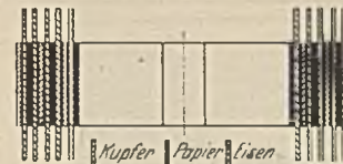
Abb. 3. Flachkupfer-Spiralspule mit Eisenzwischenlagen.
