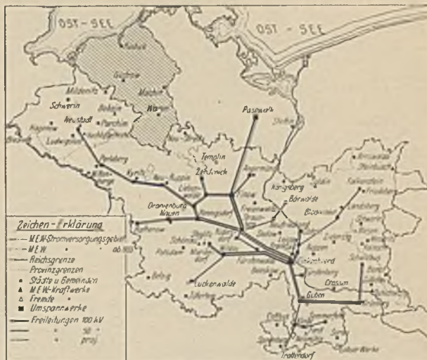
Abb. 7. Hochspannungsnetz des MEW.
