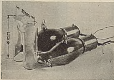
Abb. 6. Natriumlampe für Fernsehzwecke.
