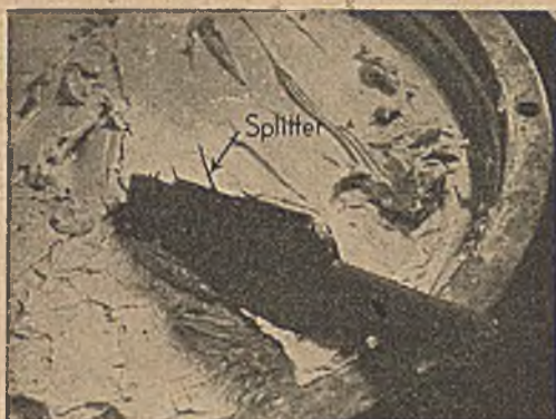
Abb. 3 Abfüllen von Maschinenfett aus dem Faß. Holzspachteln splitteln leicht, Metallspachteln sind zweckmäßiger
