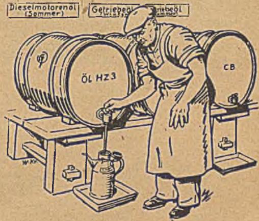
Abb. 1 Einfache Lagerung der Fässer, Abfüllen durch Hähne am Bo- denspund, Unterstellen von Tropfenfangschalen
