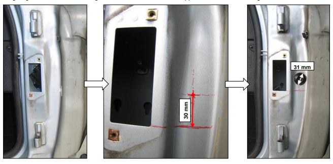
2.) Nun kann die originale Kabelbaumdurchführung mit der mitgelieferten Abdeckung verschlossen werden und eventuell zusätzlich mit Karosseriekleber abgedichtet werden.
