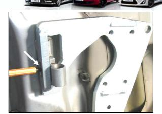
6.) Nun die Scharniere an den oben beschriebenen Punkten durchbohren und ein M8 Gewinde schneiden.
