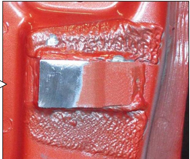
4.) Zur Befestigung der LSD-Grundplatte an der A-Säule müssen die Scharniere (oben und unten), an den nachfolgend beschriebenen Punkten, durchbohrt und ein M8 Gewinde geschnitten werden.
