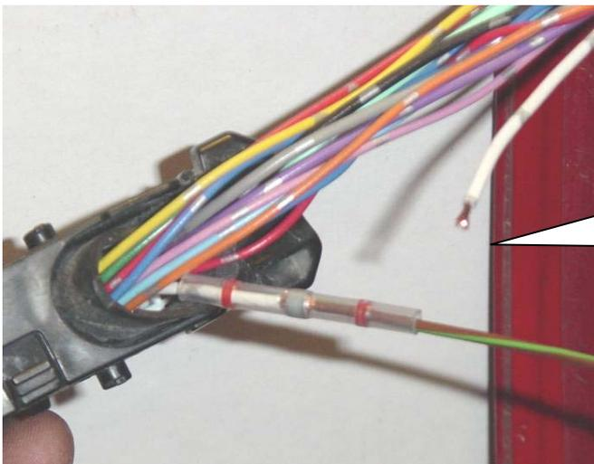
Nun jedes einzelne Kabel des Türkabelbaums mit den mitgelieferten Kabeln + Löt-Schrumpfverbindern verlängern.
