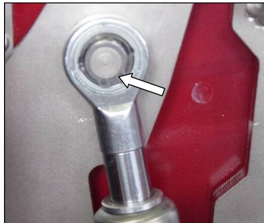
18.) Tür vorsichtig nach oben schwenken, den unteren Teil des Dämpfers am Befestigungspunkt der Grundplatte einhängen und ebenfalls mit dem beigelegten Sicherungsring sichern.
