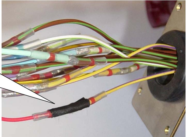
Am Schluss dann den kompletten Kabelbaum mit Hilfe des Gewebebandes wieder ummanteln.
