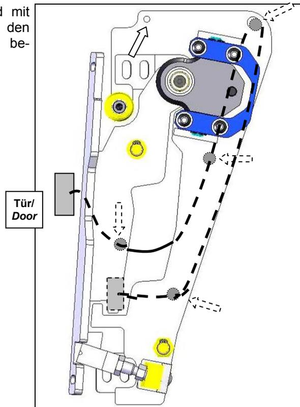
17.) Nun den Dämpfer am Befestigungspunkt des Schwenkarms einhängen und mit dem beigelegten Sicherungsring mit Hilfe einer Spitzzange sichern.
