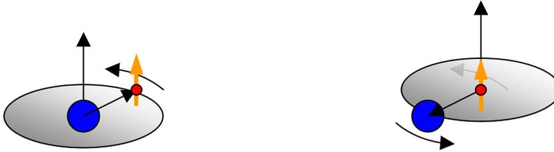
Im Laborsystem kreist das Elektron um den Kern und erzeugt ein magn. Dipolmoment bzw. ein Magnetfeld.
