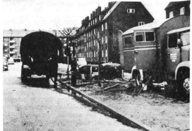
Bild 16: „Fahrbare Trinkwasserquelle“ im Einsatz in Hamburg 1962. Bundeswehr-Lkw mit aufgesetzten Falltanks übernehmen Reinwasser und verteilen es an die Bevölkerung. Hinter dem Wagen aufgebockte Falltanks für Reserve und Direktausgabe an die Bewohner der benachbarten Straßen.
