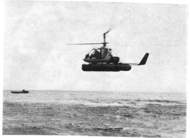
Zuladung 800 kg, Höchstgeschwindigkeit 165 km/h, Reisegeschwindigkeit 140 km/h, Gipfelhöhe 2200 m, Reichweite 200 km.
