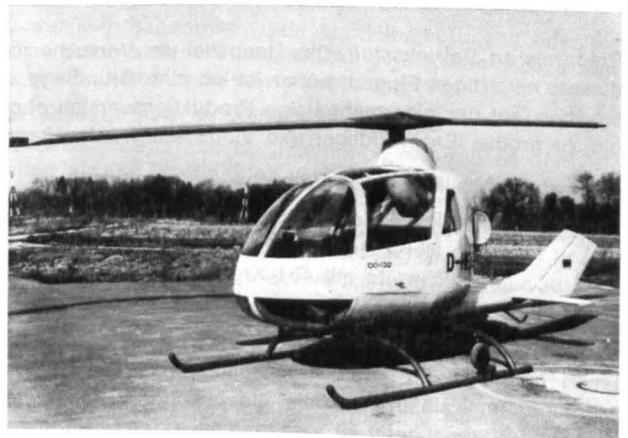
Kraftübertragungselemente unnötig gemacht werden. Bei dem einsitzigen Do 32 wird Kaltluft auf die Rotorblattenden geführt, bei dem viersitzig ausgelegten Do 132 wird jedoch der Rotor direkt durch die heißen Triebwerksgase angetrieben. Das Heizgas einer MAN-6-022-Turbine wird durch Leitungen auf die Rotorblattenden geleitet, in denen es in Düsen expandiert und so den Rotor antreibt.
