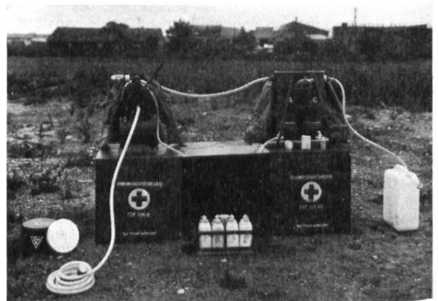
Bild 17: Tragbares Trinkwasserfiltergerät von Seitz, Nennleistung 200 l/h (links) und Zusatzgerät für A- und C- Dekontamination (rechts) mit Regenerier-Flüssigkeiten (mitte unten). Die Kombination leistet 100 l/h.
