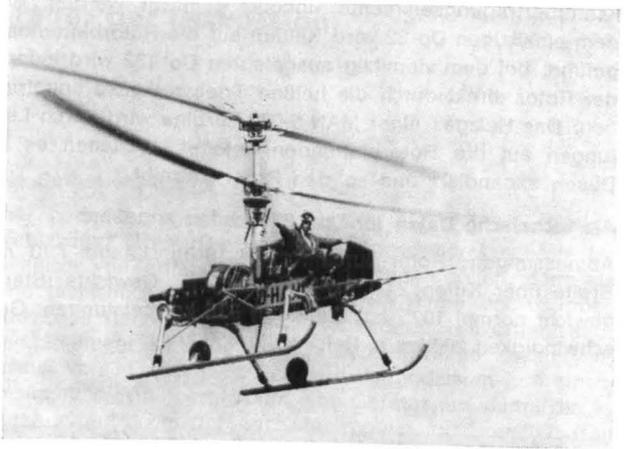
Als **technische Daten** für den Sky-Trac 1 werden angegeben: Kolbentriebwerk 260 PS, Länge 5,40 m, Breite 2,10 m, Höhe 2,95 m, Rotorblattzahl 2 mal 2, Rotordurchmesser 10 m, Leergewicht ohne Kabine 690 kg, Abfluggewicht 1500 kg,
