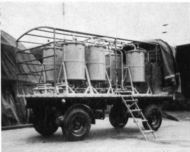
Bild 23: Fahrbare Entölungsanlage von Krupp mit einer Leistung von 10000 l/h. Werksfoto
