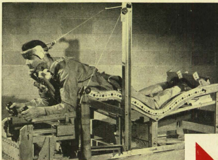
Der Pilotensitz der Raumflieger wird so aussehen. Um die gewaltigen Beschleunigungen, die während des Höhen- und Kurvenfluges auftreten, besser überwinden zu können, haben amerikanische Wissenschaftler einen neuen Weg beschritten. Versuche haben erwiesen, daß der menschliche Organismus in liegender Stellung die Beschleunigungen besser ertragen kann.
