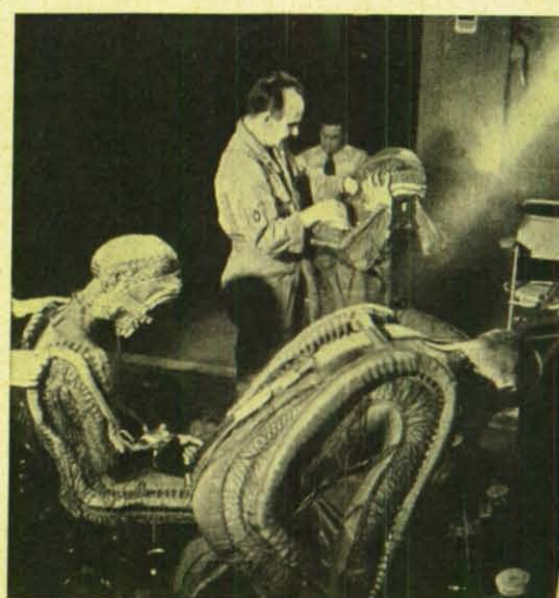
Spezialkombinationen für Stratosphärenflieger halten auch in großen Höhen den Körper der Piloten unter Normaldruck und verhindern damit die so sehr gefürchtete Blutleere des Gehirns.
