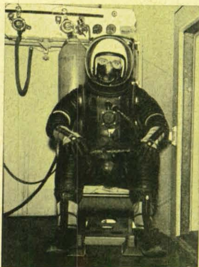
Der Druckanzug der amerikanischen Marineluftwaffe bietet ein Höchstmaß an Sicherheit für den Höhenflieger. Das Bild zeigt den Piloten unter Druckbedingungen, wie sie in 21 200 m Höhe herrschen.
