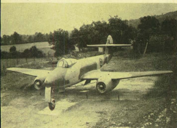
Der erste englische Turbinenjäger, die Gloster Meteor, führte im März 1943 ihren Jungfernflug aus. Das Flugversuchsprogramm wurde so eilig vorangetrieben, daß sie schon zum Ende des zweiten Weltkrieges im Einsatz über den britischen Inseln stand. Die Meteor hat sich sehr bewährt. Sie ist in 16 verschiedenen Truppenausführungen gebaut worden.
