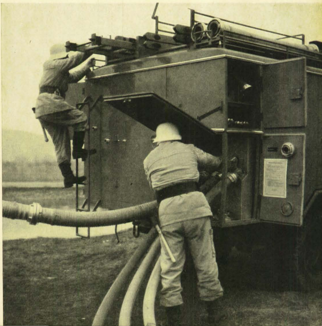
Löschfahrzeug LF 16-TS im Einsatz. Die Wasserentnahme erfolgte dabei aus einem transportablen Ausgleichsbehälter, der aus einem besonderen Kunststoffmaterial hergestellt wird.
