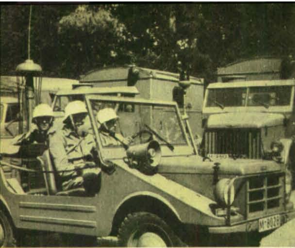
Zur Befehlsübermittlung zwischen den Führungsstellen der LS-Fachdienste dienen diese geländegängigen Fahrzeuge, die mit UKW-Funksprechgeräten (FuG 7) ausgerüstet sind.
