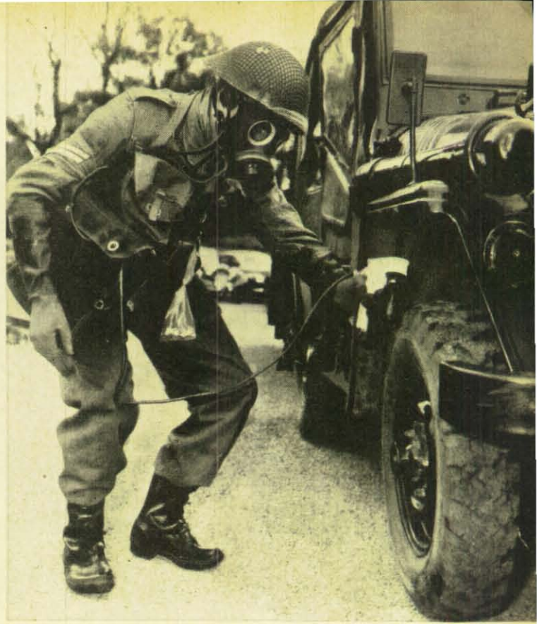
Die Handhabung der Strahlenmeßgeräte ist für die Männer des Civil Defence kein Geheimnis mehr. Bild oben: Ein Armeefahrzeug wird auf radioaktive Spuren hin untersucht. Bild unten: CD-Helfer melden das Aufspüren eines durch Fallout verseuchten Geländestreifens. ▼
