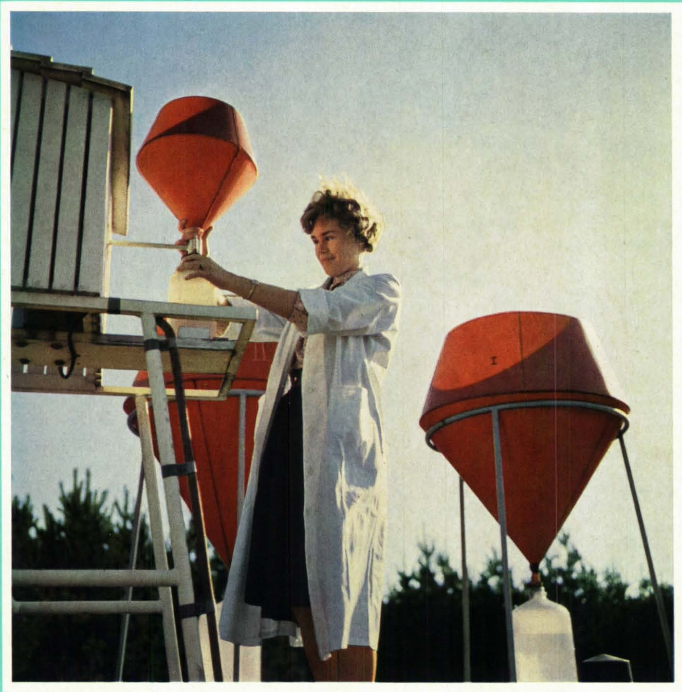
Im Karlsruher Kernforschungszentrum werden Staub- und Regenniederschläge in Kunststoffbehältern aufgefangen und auf Radioaktivität untersucht. (Siehe dazu unseren Bericht auf S. 2.)
