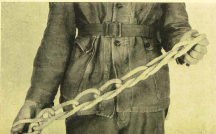
Beim dreifachen Ketttschlag hält in Notfällen, wenn eine Fangleine fehlt, sogar eine Wäscheleine dreifacher Belastung stand.
