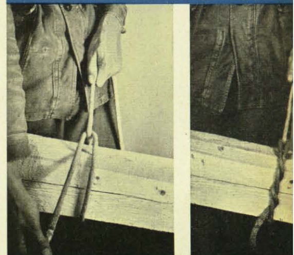
So entsteht der Zimmermannsschlag mit Halbschlag. Richtig angelegt, garantiert er eine schnelle, sichere und leicht zu lösende Befestigung der Leine an schweren Objekten.
