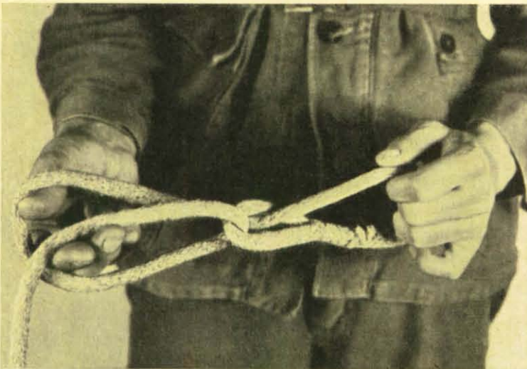
Beim dreifachen Ketttschlag hält in Notfällen, wenn eine Fangleine fehlt, sogar eine Wäscheleine dreifacher Belastung stand.
