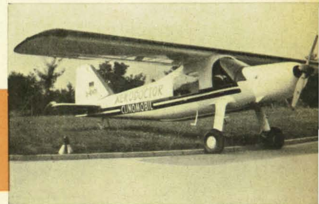
Dieses Flugzeug benötigt nur eine kurze Start- und Landebahn. Es bringt eine komplette Zeltrettungsstelle mit Personal zur Einsatzstelle. Es transportiert zwei liegende Verletzte.
