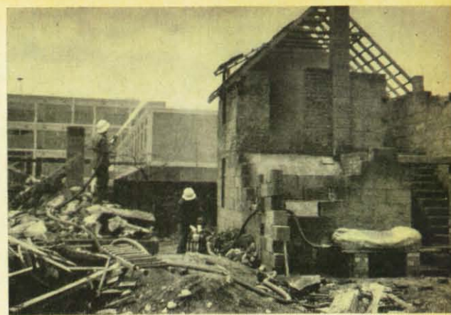
Oben: Übungsmäßiger Aufbau zur Darstellung des direkten Saugens mit einer TS 2/5. Unten: Flexi-Tank von 800 l Inhalt mit einer Rohrleitung gekuppelt. Die hohe Lagerung erhöht das Gefälle und vermindert die Saughöhe bei Ansaugen durch die Kellerluke.
