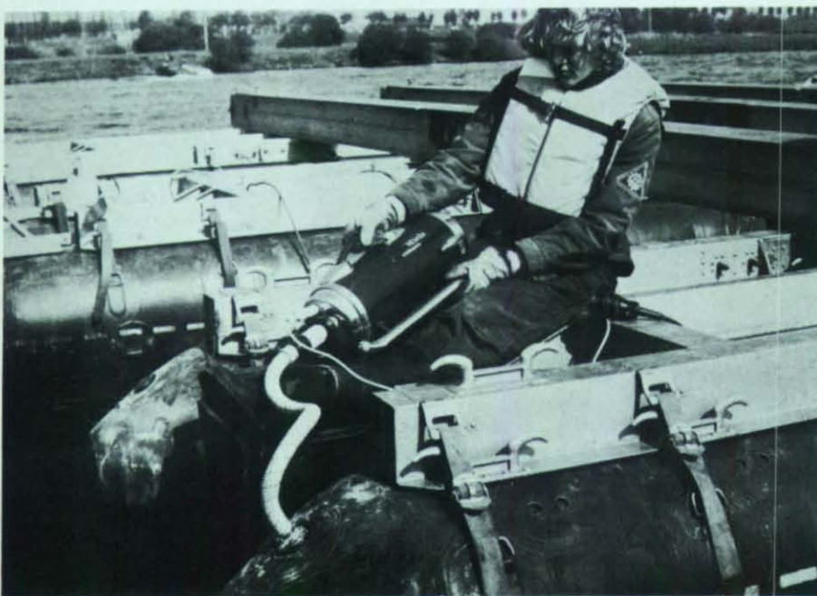
Der Versuch bewies, daß sich ein Staubsauger auch zum Aufpumpen der Schlauchboote eignet.
