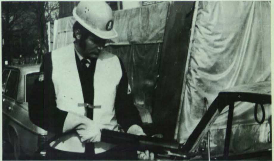
THW-Helfer führt die hydraulische Schere an einem PKW-Dachholm vor.
