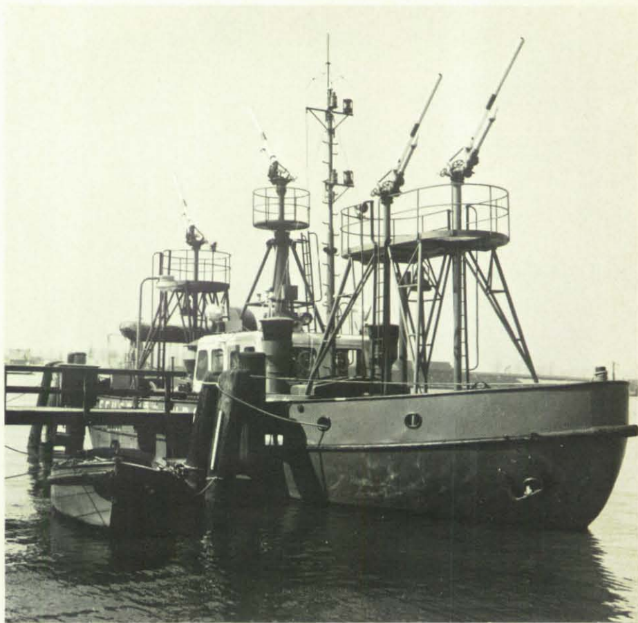
Zur Brandbekämpfung liegt vor der Einfahrt zum Ölhafen ein ständig einsatzbereites Feuerlöschboot mit vier Löschkanonen.
