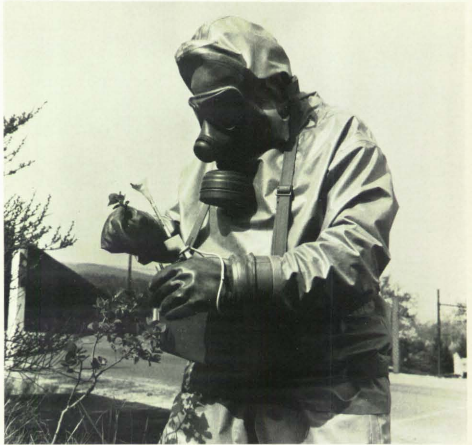
Der tragbare Spürkasten enthält Spürgeräte und Spürmittel zum Nachweis chemischer Kampfstoffe.
