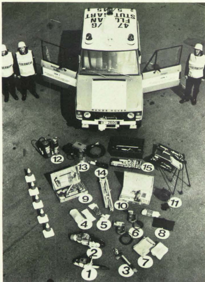
Das Fahrzeug und seine Ausrüstung: von der Motorkettensäge bis zur hydraulischen Rettungsschere.
