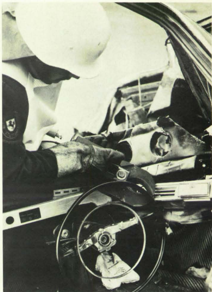
Praktische Demonstration der Einsatzmittel des SBW 1 in Stuttgart — hier die hydraulische Rettungsschere.
