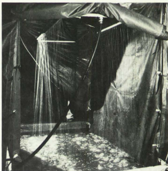
Alles klappt! Heißwasser ist vorhanden, TS 2/5 läuft, thermostatisch gesteuertes Mischventil reguliert die Wassertemperatur. Es kann geduscht werden.
