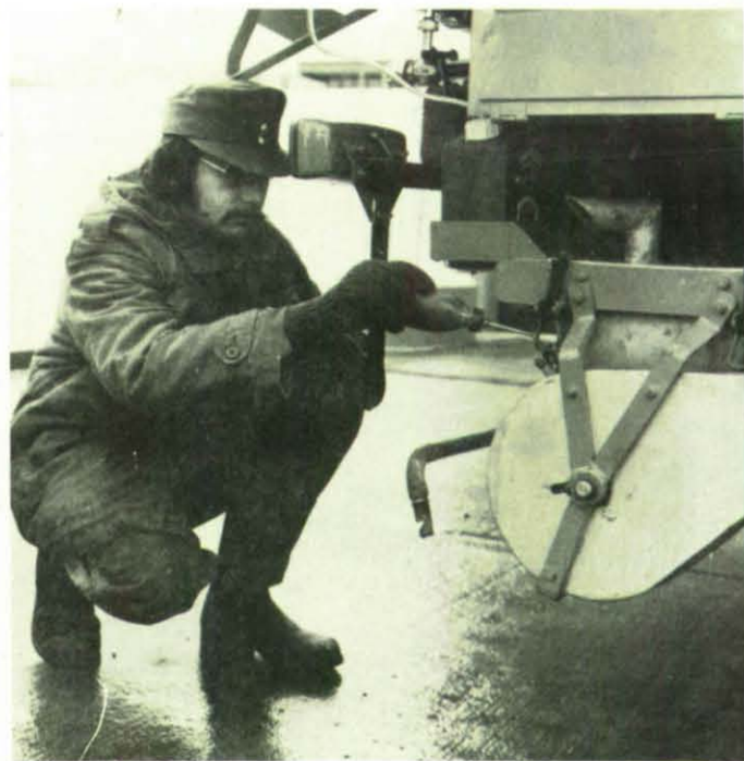
Gewußt wo! Tropfenschmierung von beweglichen Teilen der Chlorkalkstreuvorrichtung.
