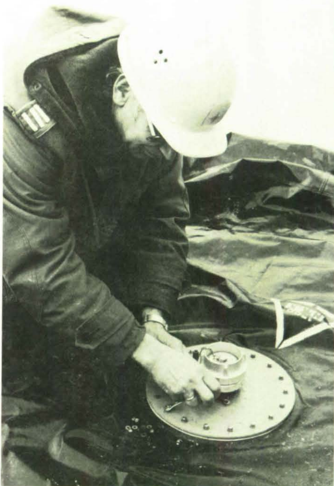
Faltbare Wasserbehälter müssen auch von innen gereinigt werden. Der Verschußdeckel hat viele Muttern!
