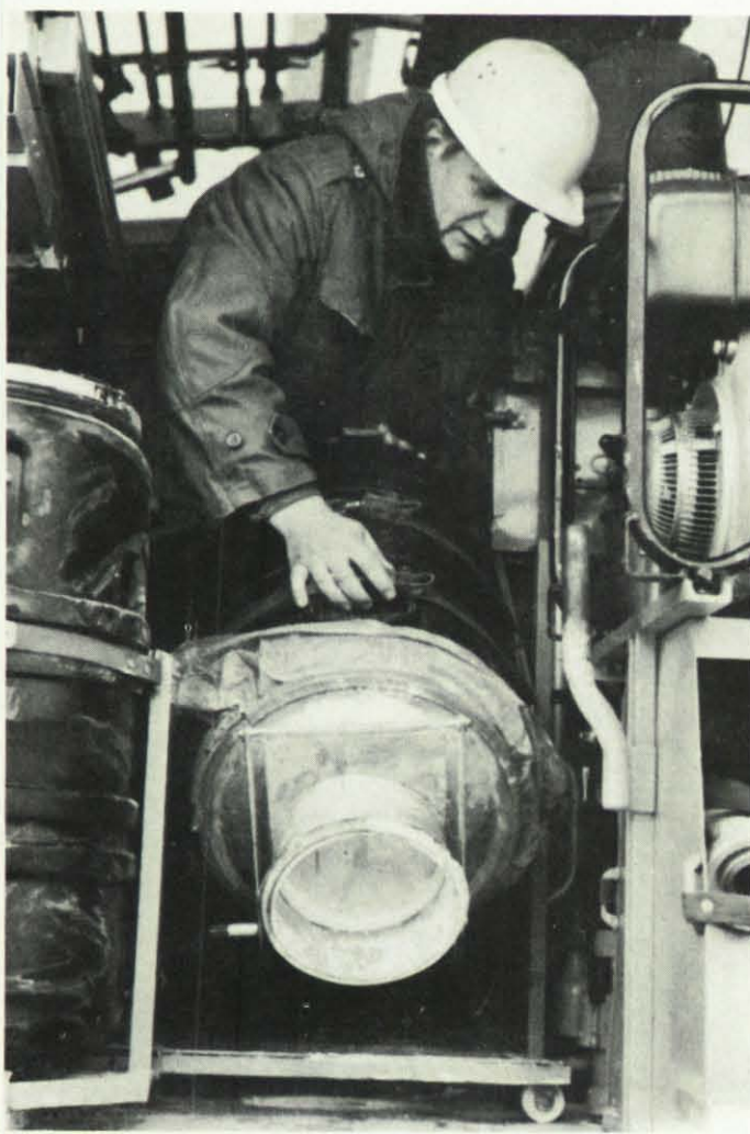
Die Streuvorrichtung für Chlorkalk wird über den Einfülltrichter beschickt. Hier wird mit nichtätzendem Material geübt.
