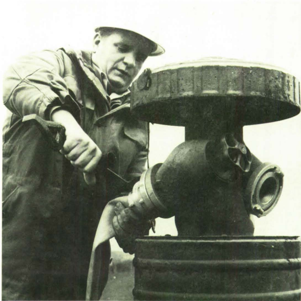
Anschluß zur Wasserentnahme aus Überflurhydrant mit Fallmantel. Macht der Helfer alles richtig?
