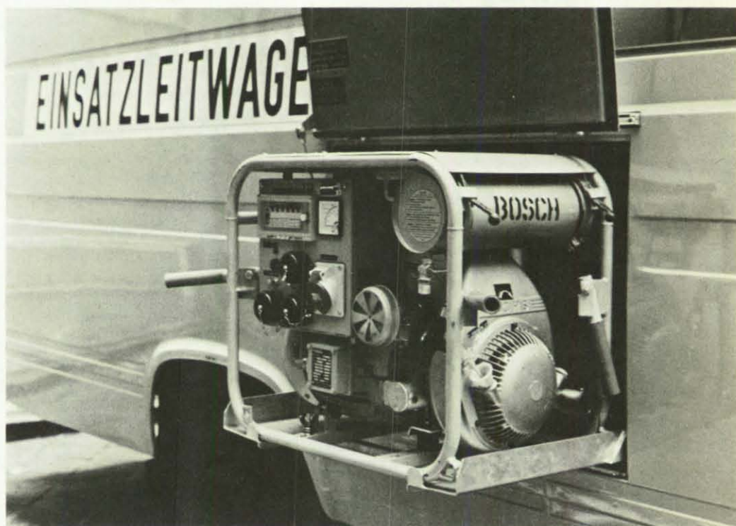
Das von außerhalb des Einsatzleitwagens zugängliche Notstromaggregat.
