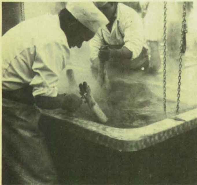
Das Wasser im Brühkessel mußte konstante Temperatur haben.
