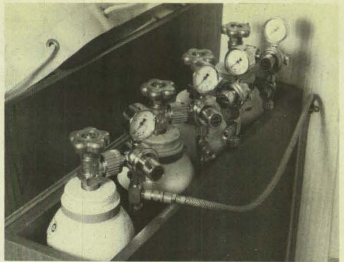
8000 Liter reiner Sauerstoff befinden sich für die eigene Sauerstoff-Aufbereitungsanlage an Bord.
