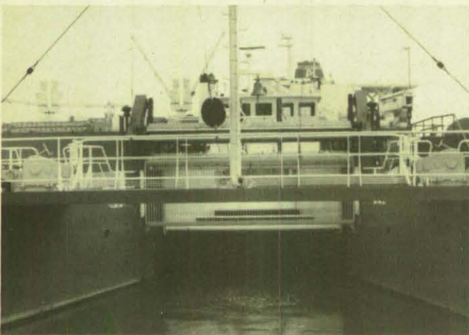
Die Ölauffanganlage der „MPOSS“, die sich durch einen besonders niedrigen Tiefgang auszeichnet.
