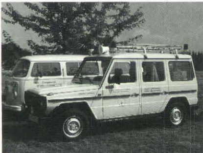
Außergewöhnliche Einsatzfahrzeuge des Katastrophenschutzes (Ergänzung): hier ein Zugtruppfahrzeug (Merc.-Benz 230 G) der Bergwacht Württemberg (Deutsches Rotes Kreuz): elfenbein (RAL 1014) mit Steckblaulichtern, Kommandolautsprecher, Dachgepäckträger und Heckrückleuchten am Dachrand.
