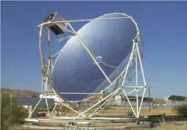
Euro-Dishs mit Stirlingmotoren
