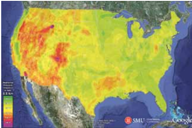
Auf der Abbildung ist das Geothermiepotential der USA in 6.000 m Tiefe dargestellt.
