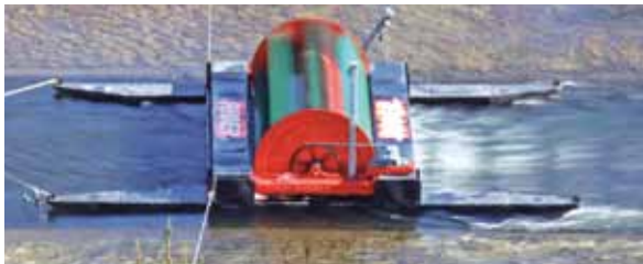
River Rider I, erster Flussmühlen-Prototyp im Auslaufbereich der Talsperre Wendefurth/Harz
