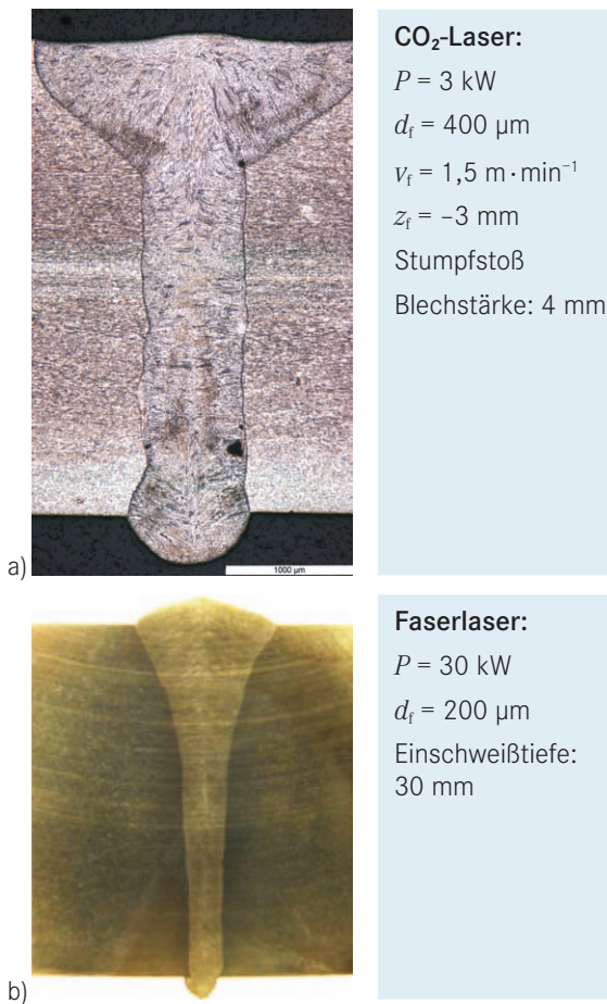
Bild 7.128 Schweißnahtdarstellung (Querschliff) des Tiefschweißens. a) Material Edelstahl, b) Material Bau-stahl /IPG2012/
