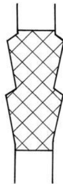
Betonplombe mit mehreren konischen Widerlagern (Betondoppelscherpfropfen)
