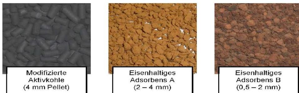
Abb. 1 – Verwendete Adsorbentien
