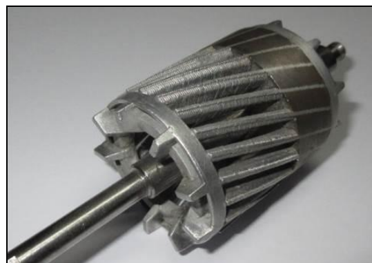
Moderner Kurzschlussanker, ein Teil der Bleche wurde entfernt (Besitz T.Klose)
