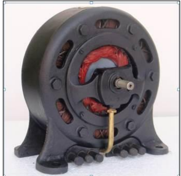
Drehstrommotor DK3, Kalb & Co. Nachfolger, Leipzig um 1920 (Besitz IG HEMB)
