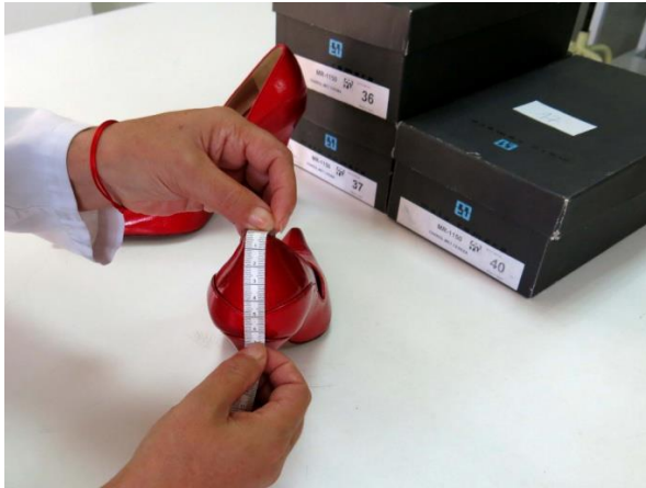
Abb. 3: Maßband, um die Länge des Fersenbogens oder Umfangsmaße festzustellen
