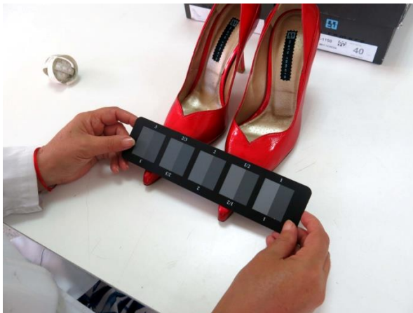
Abb.4: Grauskala zum Prüfen von Farbabweichungen vom Handmuster
