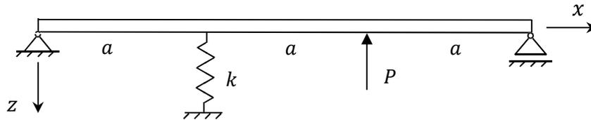
Der skizzierte masselose Balken (Länge  $3a$ , Biegesteifigkeit  $EI$ ) ist an den Endpunkten drehbar gelagert. An der Stelle  $x = a$  ist eine Feder (Federsteifigkeit  $k$ ) so befestigt, dass sie für  $w(a) = 0$  gerade entspannt ist. An der Stelle  $x = 2a$  wird der Balken durch die Einzelkraft  $P$  belastet. Mit dem eingliedrigen Ritz-Ansatz
