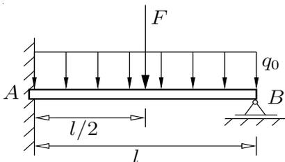
Ein statisch unbestimmt gelagerter Kragträger mit der Biegesteifigkeit  $EI$  wird mit einer konstanten Streckenlast  $q_0$  und einer Einzelkraft  $F$  belastet. Berechnen Sie die Lagerreaktionen im Punkt B und die Durchbiegung in Balkenmitte.
