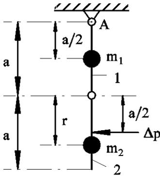
Für  $m_1 = 3m_2$  berechne man den Abstand  $r$  der Punktmasse  $m_2$ , so dass sich unmittelbar nach dem Stoß
