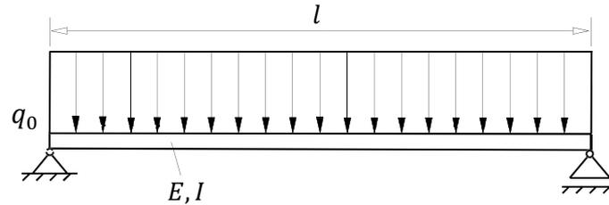
Auf einen homogenen Balken (Biegesteifigkeit  $EI$ ) wirkt eine konstante Streckenlast  $q(x) = q_0$  wie in obiger Abbildung skizziert. Mit dem dreigliedrigen Ritz-Ansatz
