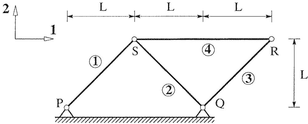
Alle Stäbe des Tragwerks haben den gleichen Elastizitätsmodul  $E$ . Die Stäbe 1, 2 und 3 haben den konstanten Querschnitt  $A$ . Der Querschnitt des Stabes 4 nimmt vom Knoten  $S$  in Richtung zum Knoten  $R$  linear ab.
