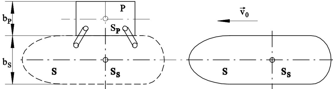
Ein Schiff  $S$  nähert sich nach Abstellen des Motors mit einer Restgeschwindigkeit  $v_0 = 0.3 \text{ m/s}$  einem Prahm  $P$  (flacher Schwimmkörper), an dem es nach Erreichen der gestrichelt gezeichneten Stellung festgebunden wird. Der Prahm sei vor dem Anlegen in Ruhe. Schiff und Prahm sollen für die Dauer des Anlegemanövers als im Wasser frei beweglich angesehen werden. Der Wasserwiderstand soll vernachlässigt werden. Die Daten seien:
