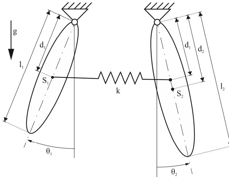
An Pendel 1 (Länge  $l_1$ , Schwerpunktsabstand  $d_1$ , Masse  $m_1$  Trägheitsmoment bezüglich des Lagers  $J_1 = m_1 l_1^2 / 3$ ) ist im Schwerpunkt eine Feder (Federkonstante  $k$ ) befestigt. Die Feder ist mit einem zweiten Pendel (Länge  $l_2$ , Schwerpunktsabstand  $d_2$ , Masse  $m_2$ , Trägheitsmoment bezüglich des Lagers  $J_2 = m_2 l_2^2 / 3$ ) verbunden. Die Feder ist für  $\theta_1 = \theta_2 = 0$  entspannt.
