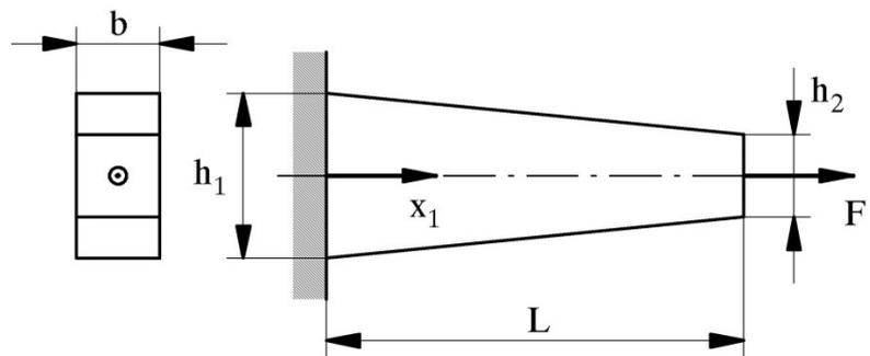
a) Entwickeln Sie die lokale Steifigkeitsmatrix für ein sich verjüngendes Stabelement mit einem linearen Verschiebungsansatz.
