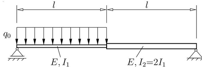
Berechnen Sie zunächst nur die Durchbiegung. Führen Sie hierzu eine geeignete Hilfskraft  $F_H$  ein.
