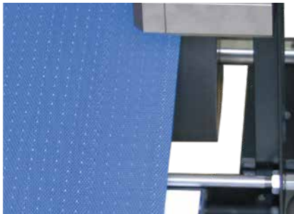
Infrarot-Kantensensor FR 52 zur Kantenerfassung von Gittergewebebändern
