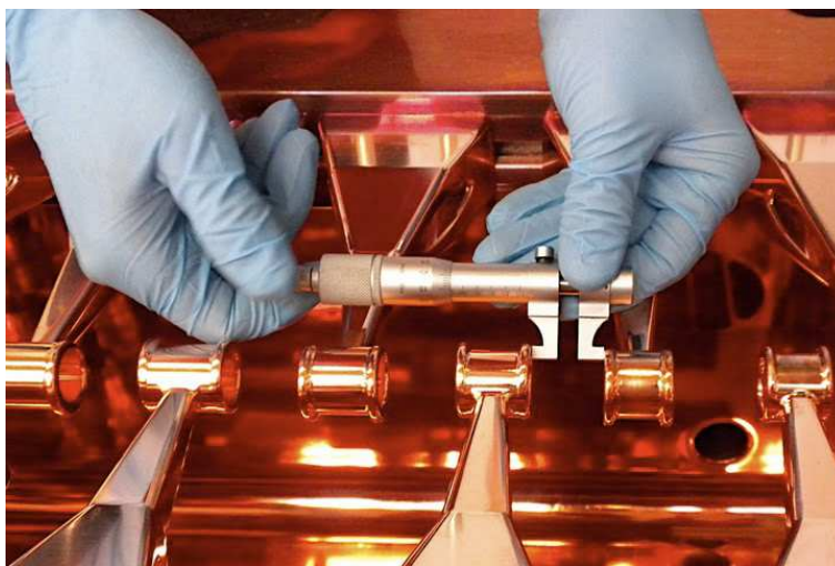
Abb. 8.56: Fotografie einer Kontrollmessung der Spaltlängen an der zusammengebauten IH-Struktur
