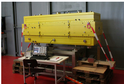
Abb. 6.20: Fotografie des Störkörpermessaufbaus zum Test der BNL IH-Struktur (links) und Schema einer Störkörpermessung (rechts)
