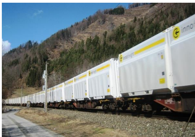
Abbildung 7: Überbreite Behälter auf Containertragwagen (Quelle: innofreight.ch )
