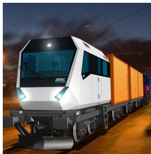
Abbildung 5: Pendelzugeinheit der railCare AG (Quelle: railCare AG) und aufsteckbare Führerkabine (Quelle: ASK Cargojet)
