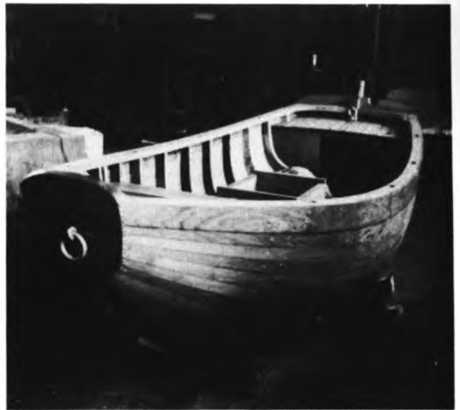
Der rundspantige Kahn mit Bunn für W. Busstorf sieht seiner Vollendung entgegen. Er ist im letzten Bild bereits geölt (Leinöl) und fast schon fertig für die Bootstaufe.
