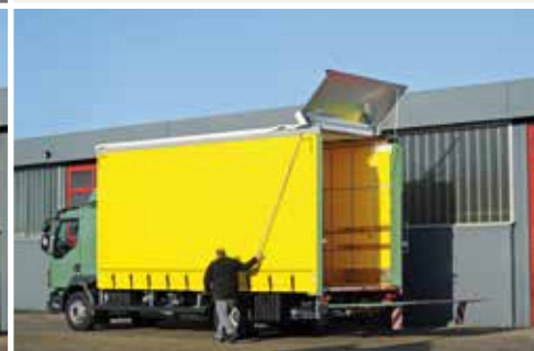
Öffnen des Schiebverdecks Opening the sliding roof
