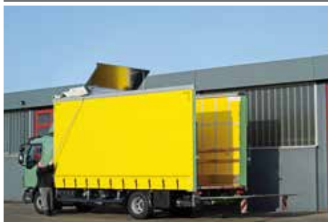
Feststellen des geöffneten Verdecks
