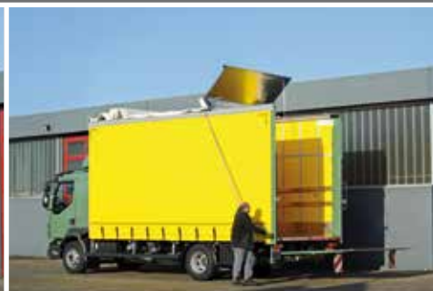
Schließen des Schieberverdecks
