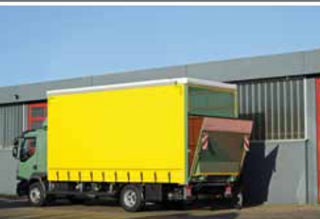
Hydraulisches Öffnen der Ladebordwand
