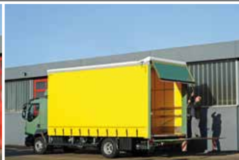
Manuelle Entriegelung und automatisches Aufschwingen des TailWing
