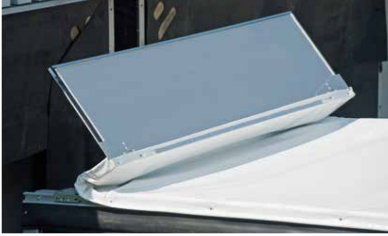
Elastisches Zurückschwingen bei Wandberührung Elastic swing back if a wall is touched
