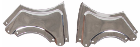
Behälterstützen - (Teil 3L und 3P )
