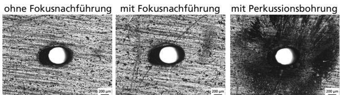
Im Folgenden werden die Verfahrensbewegungen mit Fokuspnachführung und ohne Fokuspnachführung mit Fokuspposition  $z = -1,5$  mm detaillierter untersucht. In Bild 67 sind Ein- und Austrittsdurchmesser sowie die Dicke der Schmelzrückstände und die entsprechenden Konizitäten von jeweils 115
