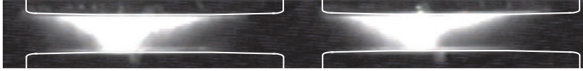
Abbildung 6.11: Bogen bei I = 21 \text{ kA} kurz nach dem Stromschiebel, Momentanwert i = 30 \text{ kA}
