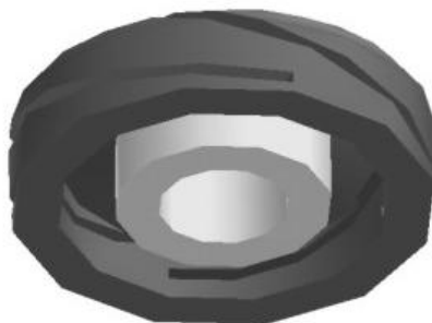
Abbildung 5.2: Dunkel: Kupferkontakt; Hell: Innenring aus Edelstahl
