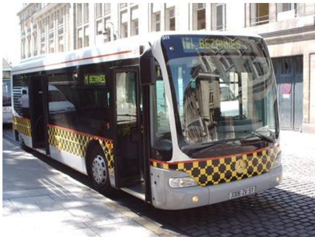
Abbildung 19: Midibus Cito von Evobus mit Hybridtragstruktur [13]
