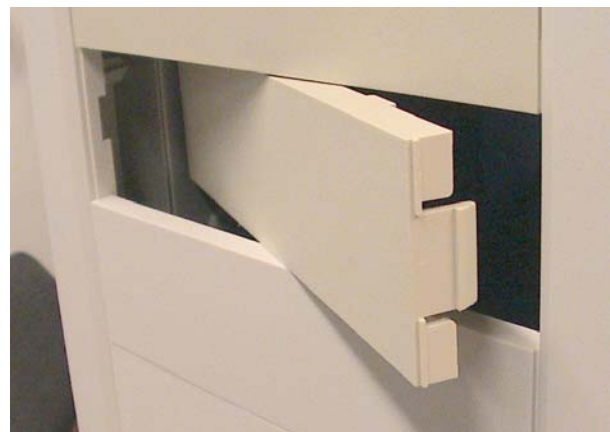
Abbildung 7: Nietverbindung an Stahlträgern im Hochhausbau (links), Schnappverbindung an einem PC-Gehäuse (rechts)
