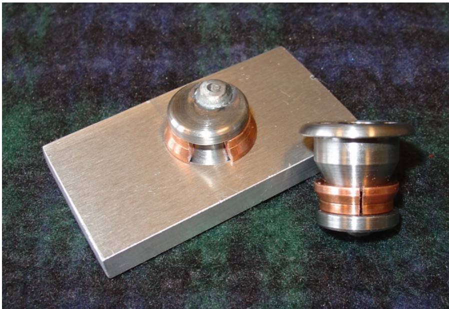
Abbildung 78: Fertige Prototypen der SE-Schraube, rechts im ungefügten, links im gefügten Zustand
