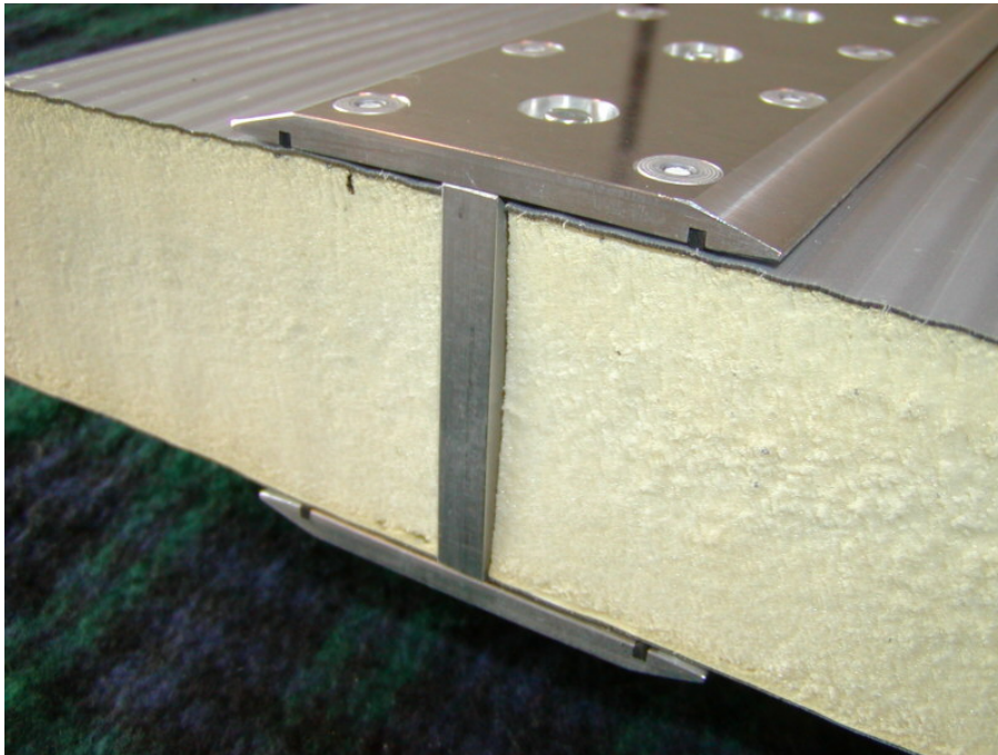
Abbildung 62: Fertiger Prototyp des Blindnietverbinders, Bild 2
