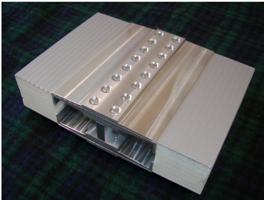
Abbildung 53: Fertiger Prototyp des Standardschraubenverbinders, Bild 1
