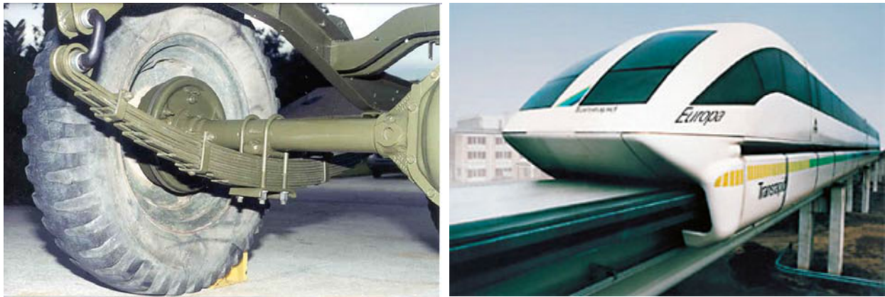
Abbildung 9: Kraftschlüssige Radaufhängung durch Blattfedern an einem Geländewagen (links), Magnetschwebbahn (rechts)
