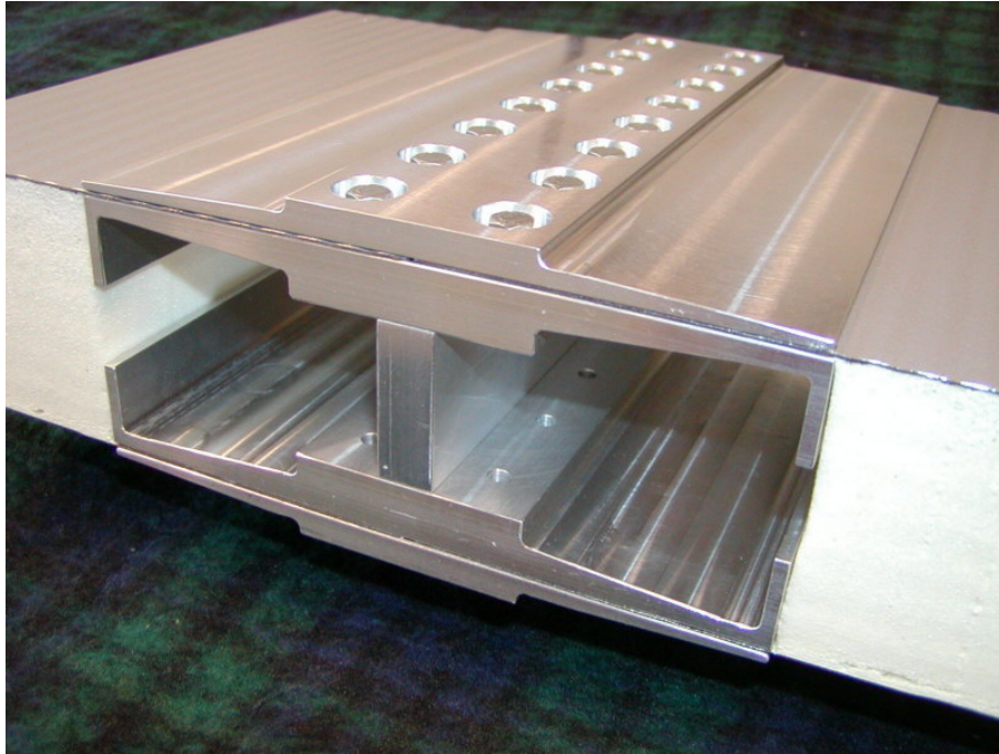
Abbildung 54: Fertiger Prototyp des Standardschraubenverbinders, Bild 2
