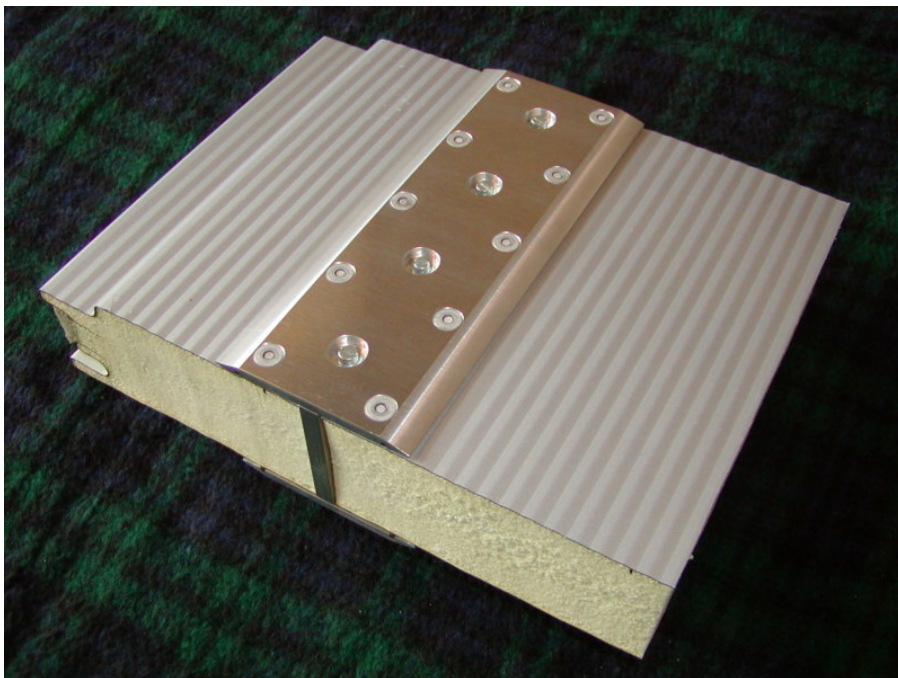
Abbildung 61: Fertiger Prototyp des Blindnietverbinders, Bild 1
