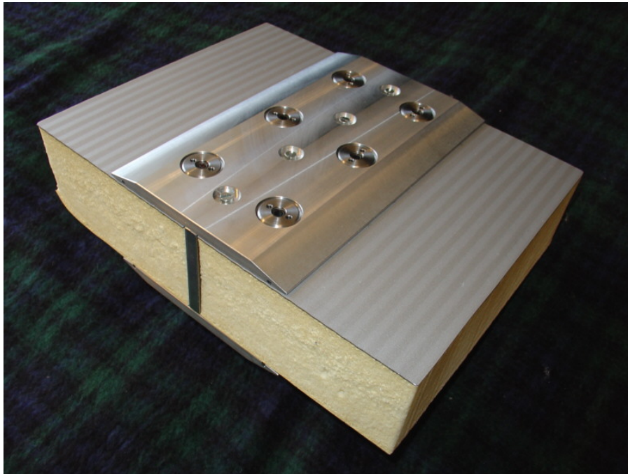
Abbildung 76: Fertiger Prototyp des SE-Schrauben-Verbinders, Bild 1
