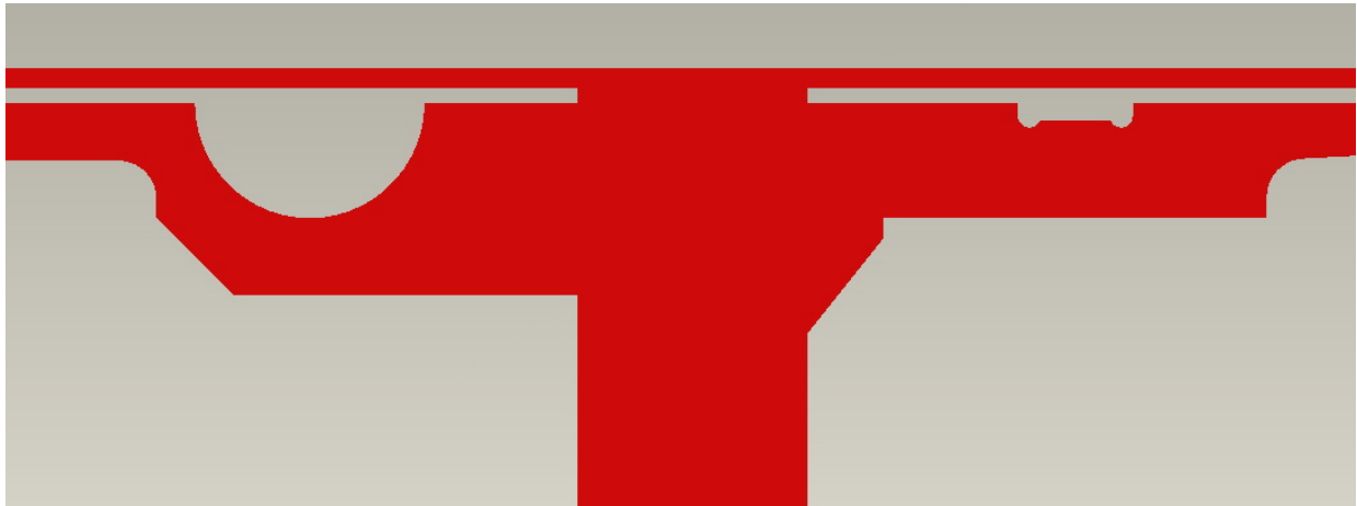
Abbildung 80: Querschnitte der Vertiefungen in den inneren VE-Zungen für Körnen (links) und Durchsetzfugen (rechts)
