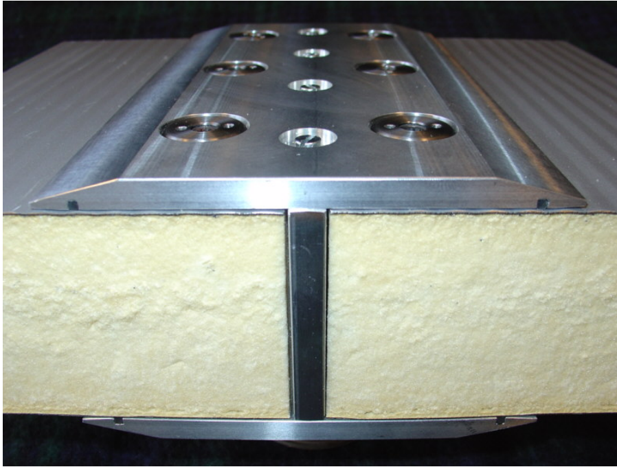
Abbildung 77: Fertiger Prototyp des SE-Schrauben-Verbinders, Bild 2
