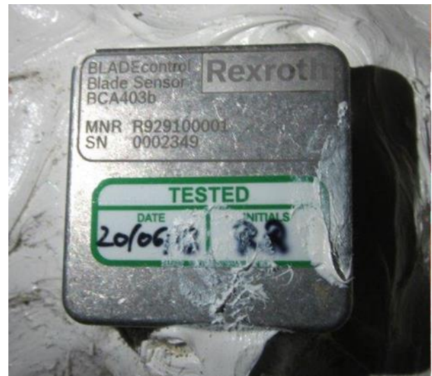
Abb. 8: Beschleunigungssensor-Modul BCA403b von Bosch Rexroth.
