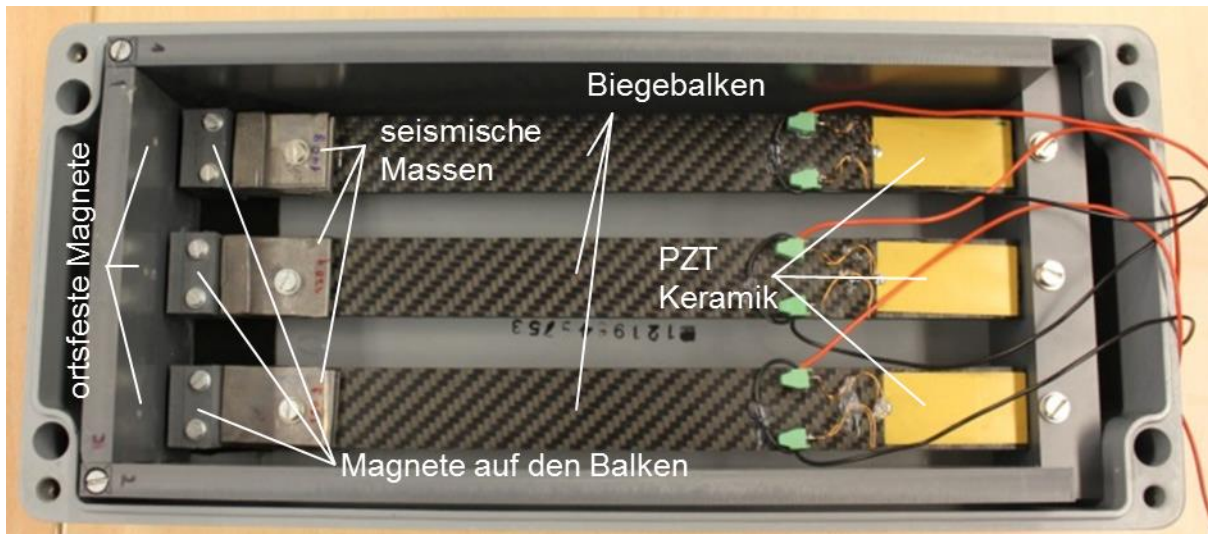
Abb. 58: Bistabil betriebener Bimorph-Array Energy Harvester.
