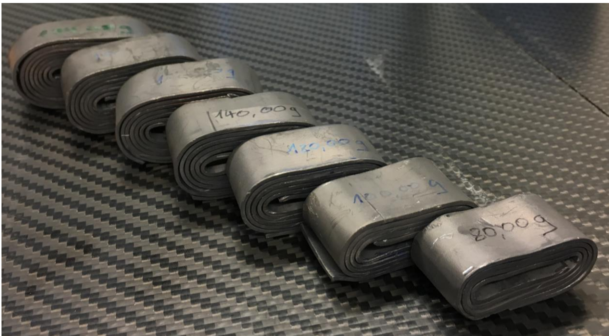
Abb. 40: 7 Seismische Massen (80-194 g) aus Blei bestehend.
