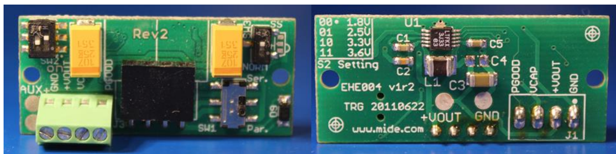
Abb. 45: Energieaufbereitungsmodul EHE-004 von Midé Technology Corporation.
