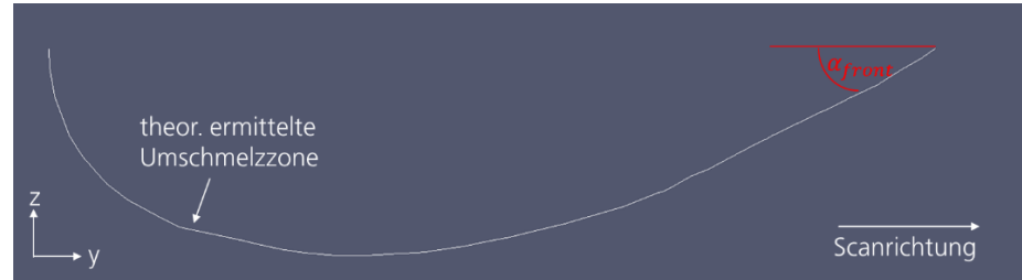
Bild 23: Bestimmung des Neigungswinkels des Schmelzbades an der Schmelzfront \alpha_{front} an der theoretisch ermittelten Umschmelzzone (Strahlgeometrie: Linie 1500x400 \mu\text{m}^2 , v=50 mm/s, I=110 \cdot 10^3 W/cm ^2 )
