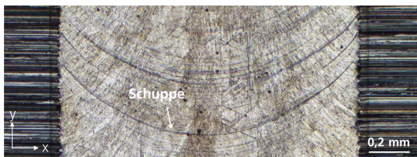
Bild 25: Schuppe auf Einzelspur (Strahlgeometrie: Linie 1500x400 \mu\text{m}^2 , v=50 mm/s, I=130 \cdot 10^3 W/cm ^2 )
