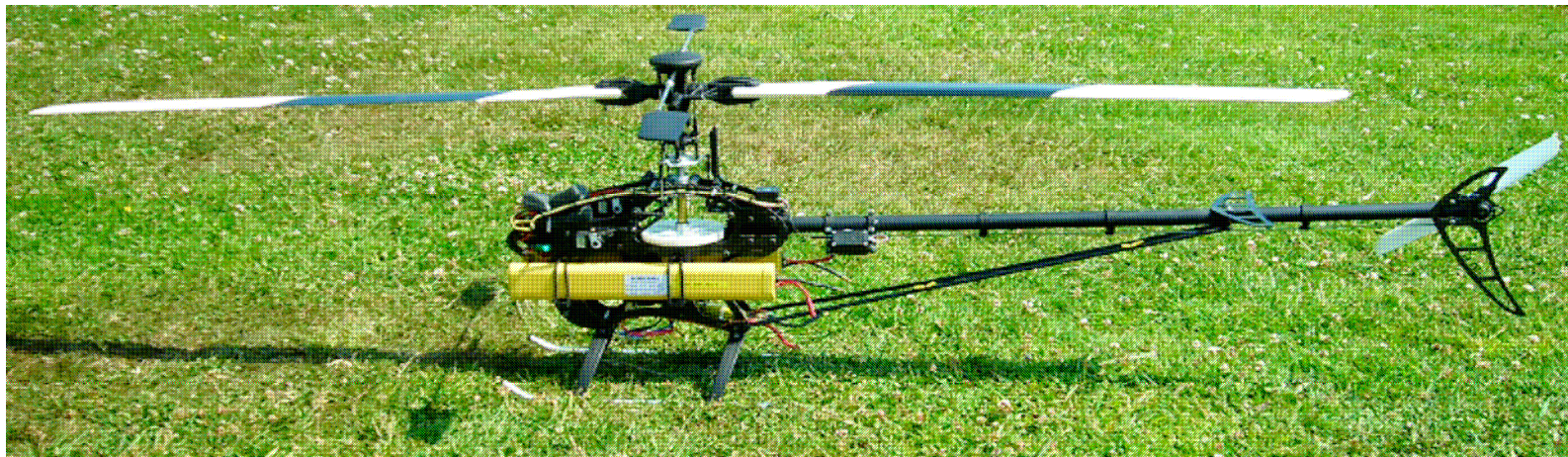
Versuchsträger auf Basis eines elektrogetriebenen Modellhubschraubers
