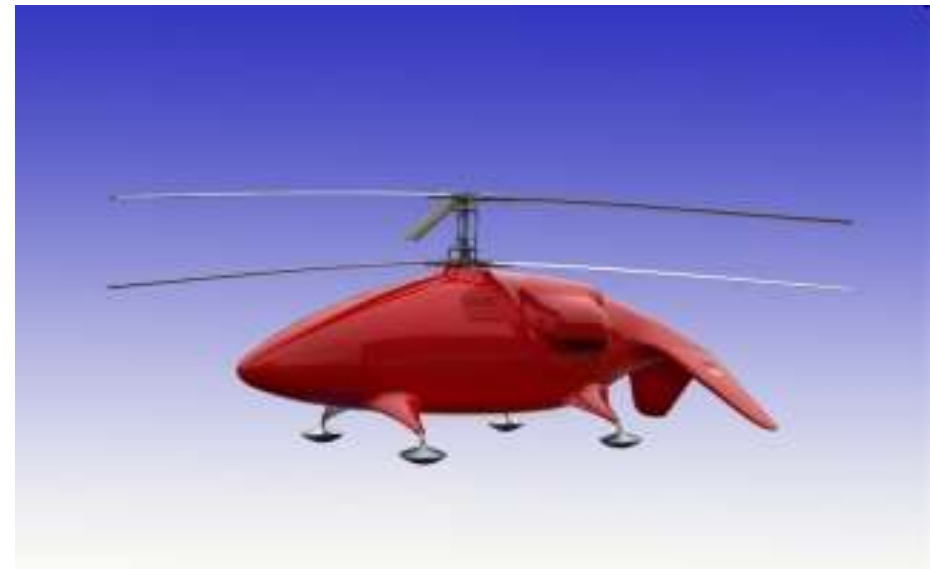
SHARC – Koaxial-Rotor UAV mit 200 kg Abflugmasse [1]
