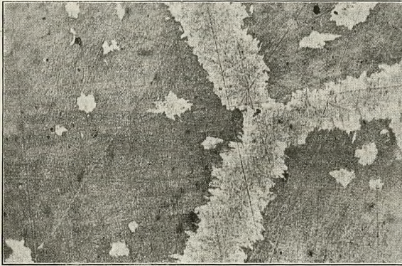
Abbildung 8. Die Legierung der Abb. 7 nach längerem Ausglühen. Die Dunkelfärbung des vorher hellen Gebiets zeigt die mikroskopisch homogene Ausscheidung in diesem Gebiet.
