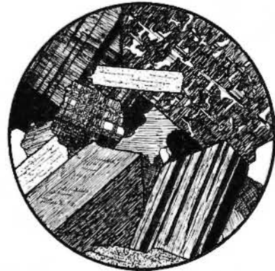
Abb. 53. Die Feldspatarten des Granits. Orthoklas links unten, Mikrotin rechts von der Mitte, Perthit rechts oben, Plagioklas rechts unten und links oben.
