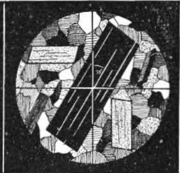
Abb. 17. Schiefe Auslöschung (Augit).
