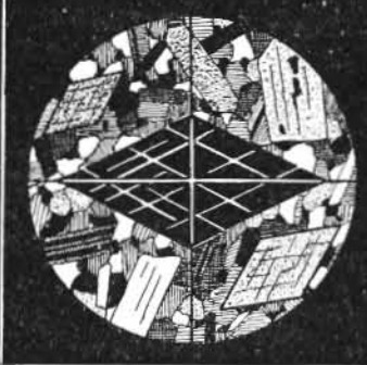
Abb. 16. Symmetrische Auslöschung (Hornblende).
