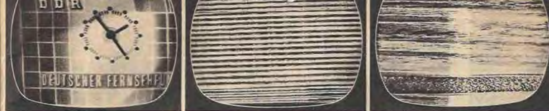
Geringe Abweichung der Zeilenfrequenz Mittlere Abweichung der Zeilenfrequenz Große Abweichung der Zeilenfrequenz
