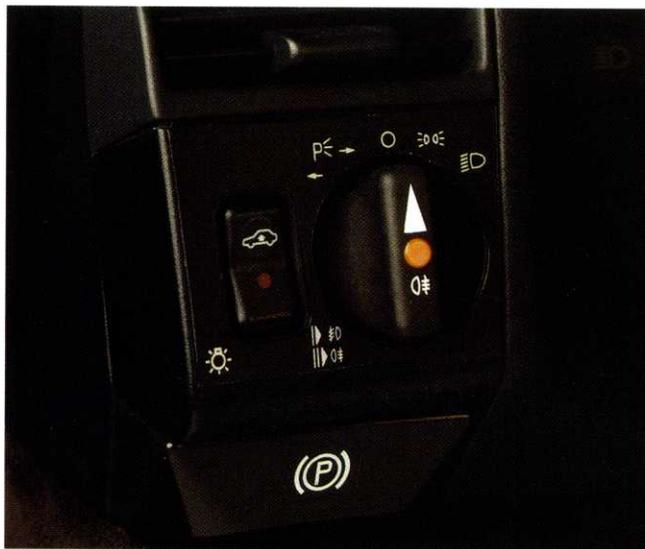
Als spezielle Vorsorge zum Befahren von schlechten Straßen kann das Fahrzeugniveau durch Betätigen eines Wippschalters in der Armaturenanlage um 30 mm aus der Normal-Fahrstellung angehoben werden.
