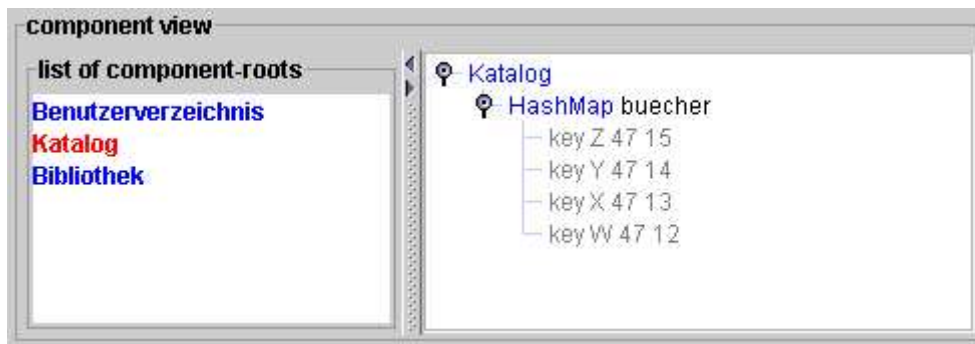
Abbildung 12 Die Sicht auf die Komponenten des inspizierten Programmes mit der Liste der Komponenten und einem ausgewählten Komponentenbaum.
