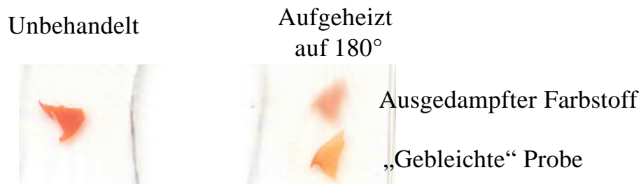
Abb. 5.10 : Demonstration des thermischen Ausdampfeffektes. Vergleich einer unbehandelten DR1/PMMA Probe vor und eine anderer Probe gleicher Konzentration nach Aufheizen und Separierung der Glaszelle. Man erkennt, daß sich der DR1-Farbstoff auf dem oberen Glas niedergeschlagen hat, und somit aus dem Polymer gedampft ist.
