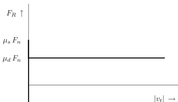
**Abbildung 3.4:** Reibmodell mit Haft- und Gleitreibung
